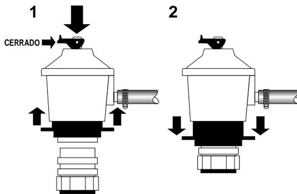
1. Con el regulador en posición CERRADO y los artefacto APAGADO, tire del anillo hacia arriba y presione el regulador sobre la válvula del cilindro.
