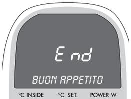
**NOTE:** La temperatura indicata in basso a sinistra nel display aumenta durante la cottura. Una volta raggiunta quella impostata, verranno emessi tre brevi segnali acustici e rimarrà visualizzato solo il valore di temperatura impostato. E' possibile modificare la temperatura impostata anche durante la cottura, semplicemente premendo il tasto **TEMPERATURE** (7)
