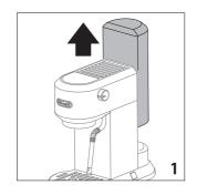
•打开水箱盖(A1),往水箱(A2)中注入清水,注意不要超过—MAX-(最高水位)线(如图2)。 请注意:须注入新鲜饮用水。不要使用气泡水 (碳酸水)或蒸馏水。
