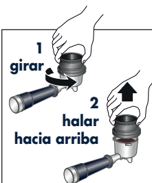
5. Retire el embudo dosificador y compruebe la dosis de café (consulte la sección "3.2 La dosis perfecta").
