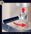
正确安装咖啡手柄,将手柄与"插入(INSERT)"字样对齐,然后将其向右旋转,直至与"关闭(CLOSE)"字样对齐。
