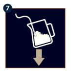
蒸汽喷嘴应始终浸入牛奶 液面,但不要让太多空气 进入,避免产生大气泡。
