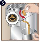
对应指示灯常亮,将奶缸 放置在蒸汽杆下方:将蒸 汽杆浸入牛奶中,然后打 开蒸汽旋钮。
