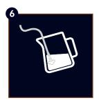
将蒸汽杆浸入牛奶液面下 方适当位置,蒸汽冲力会 把空气混合进牛奶,形成 细密的奶泡。
