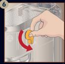
将热水/蒸汽旋钮转到 € **/ %** 位置,排空水箱;然后将 旋钮转到"0"。此操作 是制作奶泡前,清洗蒸汽 回路。
