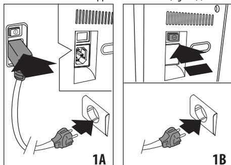
2. Pour les modèles avec cordon fixe : brancher l'appareil sur secteur et s'assurer que l'interrupteur général (A23), situé à l'arrière de l'appareil est enfoncé (fig. 1B) ;
