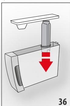
14. "RINCER ET REMPLIR D'EAU JUSQU'AU NIVEAU MAX" (fig. 3) : Remplir le réservoir jusqu'au niveau MAX avec de l'eau fraîche ;
