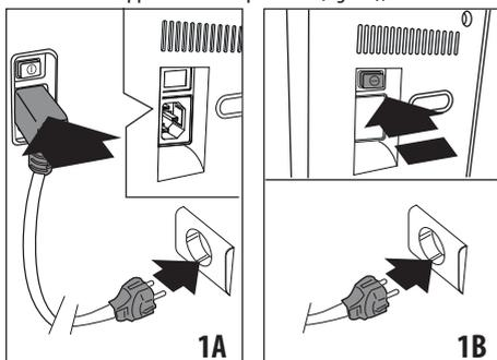
2. Per modelli con cavo fisso: collegare l'apparecchio alla rete elettrica e assicurarsi che l'interruttore generale (A23), posto sul retro dell'apparecchio sia premuto (fig. 1B);
