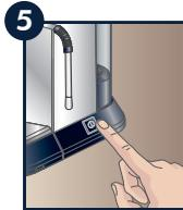
5 Brancher la machine sur secteur et appuyer sur l'interrupteur général.
