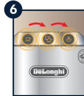
6 La machine effectue un test diagnostic, signalé par le clignotement en séquence des voyants.
