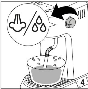
Bevor Sie die Siebträgermaschine benutzen können, muss der Innenkreislauf der Maschine durchgespült werden. Gehen Sie wie folgt vor:
