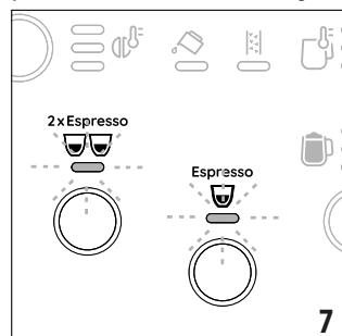
Cuando las luces dejan de parpadear y todas los indicadores luminosos del panel de control permanecen encendidos de manera constante, la máquina está lista para el uso.
