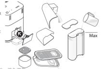
清潔過程結束後, 關閉咖啡機。使用把手或旋卻 移除除鱗管, 小心存放。倒空滴水盤和廢棄粉囊容
