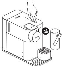
② 拆下水箱。拉起并关闭手柄，以便弹出任何剩余的粉囊。在咖啡出口下方放置一个容器。
