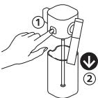
Retirez le réservoir de lait en appuyant sur le bouton situé sur le côté du pot à lait.
