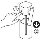
Stlačte tlačidlo na boku nádoby na mléko a odnímte ju. Odpojte hadičku na přívod mléka.
