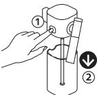
Retire a tampa do depósito do leite, pressionando o botão que está na lateral da tampa. Retire o tubo de aspiração do leite.
