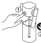
Rimuovere il contenitore del latte premendo il pulsante sul lato e staccare il tubicino di aspirazione del latte.
