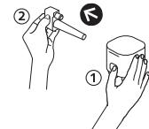
Appuyez sur le bouton situé sur le côté du pot à lait et tirez pour déverrouiller le connecteur du Rapid Cappuccino System.
