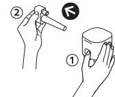
Premere il pulsante sul lato del contenitore e tirare per sbloccare il connettore del sistema Rapid Cappuccino.
