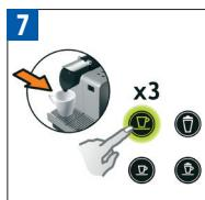
Machine doorspoelen: Plaats een opvangbak onder de koffie-uitloop en druk de Lungo-toets in. Herhaal deze handeling driemaal.
