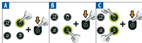
Houd de aangegeven toetsen ingedrukt en schakel de spanning van de machine in.
