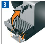
Open het opbergvakje met het ontkalkingspijpje. Πλαστήστε το οπέργιο της μηχανής. Ανοίξτε τη θύρα αποθήκευσης του σωλήνα καθαρισμού καθαλατώσεων. Συνδέστε τον σωλήνα στη σύνδεση ατμού της μηχανής.
