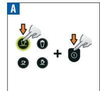
Houd de Lungo-toets ingedrukt en schakel de spanning van de machine in.
