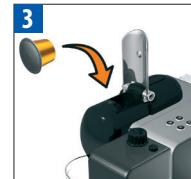
Hebel vollständig öffnen und Kapsel einlegen.
