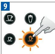
Cappuccino Taste erneut drücken. Der Spülvorgang des Kaffeeauslaufs, der Entkalkungsdüse und der Abtropfschale fährt fort bis der Wassertank entleert ist. Cappuccino und Latte Macchiato Tasten blinken abwechselnd. Premere ancora il pulsante Cappuccino. Il ciclo di risciacquo continua attraverso l'erogatore di caffè, il tubo di decalcificazione e il vassoio raccogligocce fino a quando il serbatoio dell'acqua rimane vuoto. I pulsanti Cappuccino e Latte Macchiato lampeggiano alternativamente.
