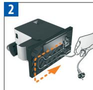
Verwijder het waterreservoir, het lekbakje en het reservoir voor gebruikte capsules. Maak de voedingskabel op de gewenste lengte in berg de rest van de kabel op in de ruimte aan de onderzijde van de machine.
