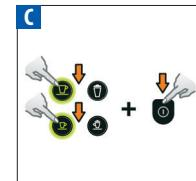
Houd de Espresso- en de Lungo-toets samen ingedrukt en schakel de spanning van de machine in.
