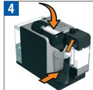
Sluit de capsuleklem, plaats een Cappuccino kop of Latte Macchiato glas onder de koffie-uitloop en breng het melkventiel in positie.
