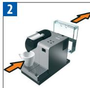
Wassertank entfernen. Hebel schließen (es darf keine Kapsel eingelegt sein). Behälter unter den Kaffeeauslauf stellen.
