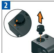
Schaumregulierer entfernen, indem Sie ihn in die entsprechende Position drehen ➤ und abnehmen.
