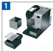
**■** Gebruik geen agressieve schoonmaakmiddelen of oplosmiddelen voor de reiniging van de machine. Gebruik een vochtige doek en een mild schoonmaakmiddel om het oppervlak van de machine schoon te houden. Machine niet in de vaatwasser plaatsen!
