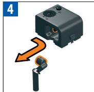
Milchdüse entfernen, indem Sie sie herausdrehen.
