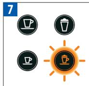
Sobald der Entkalkungsvorgang beendet ist (Wassertank läuft leer) blinkt die Cappuccino Taste. Quando il ciclo di decalcificazione è terminato (il serbatoio dell'acqua rimane vuoto), il pulsante Cappuccino lampeggia.
