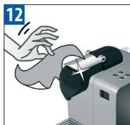
Maschine mit einem feuchten Tuch reinigen. Die Maschine ist fertig entkalkt. Pulire la macchina usando un panno umido. La decalcificazione della macchina è ora terminata.
