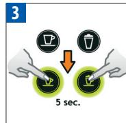
Cappuccino und Espresso Tasten gleichzeitig für 5 Sekunden gedrückt halten. Tasten blinken abwechselnd: Entleerungsmodus läuft.
