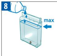
Maak het reservoir voor gebruikte capsules en het lekbakje leeg; spoel ze met water na en vul vervolgens het waterreservoir met drinkwater tot aan het maximumniveau, aangeduid door MAX. Ήρθατε στη στάγη 5. Αδειάστε το δοχείο χρησιμοποιημένων καψουλών, το δίσκο αποστράγγισης, ξεπλύνατε και γεμίστε το δοχείο νερού με φρέσκο πόσιμο νερό έως την ένδειξη επιπέδου MAX. Επαναλάβετε το βήμα 5.
