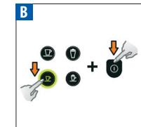
Houd de Espresso-toets ingedrukt en schakel de spanning van de machine in.
