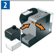
Plaats het deksel op het melkreservoir. Open het opbergvakje van de stoomaansluiting door het paneel naar rechts te schuiven. Sluit het Rapid Cappuccino Systeem aan op de machine. Melkrecept-knop knippert: het Rapid Cappuccino Systeem warmt op. Indicatielampjes branden constant: machine is klaar voor gebruik.
