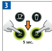
Druk de Cappuccino- en de Espresso-toets tegelijk in en houd ze 5 seconden vast. De snelkeuzetoetsen knipperen om te beurten: machine wordt geleegd
