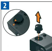
Verwijder de regelknop voor het melkschuim door deze in de stand (►) te draaien en omhoog te verplaatsen.
