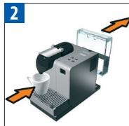
Verwijder het waterreservoir. Sluit de capsuleshouder (zonder capsule in machine). Plaats een opvangbakje onder de koffie-uitloop
