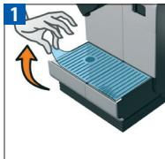
Verwijder de plastic beschermfolie van de roosters links en rechts, en van de machinepanelen.
