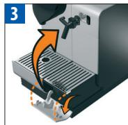
Öffnen Sie das Aufbewahrungsfach der Entkalkungsdüse. Stecken Sie die Entkalkungsdüse an den Dampfanschluss.
