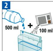
Maak het lekbakje en het reservoir voor gebruikte capsules leeg. Vul het waterreservoir met 100 ml Nespresso ontkalkingsoplossing en 500 ml water. Αδειάστε το δίσκο αποστράγγισης και το δοχείο χρησιμοποιημένων καψουλών. Γερίστε το δοχείο νερού με 100 ml από το προϊόν καθαρισμού καθαλατώσεων Nespresso και 500 ml νερού.
