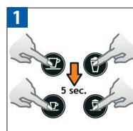
Alle vier Tasten für 5 Sekunden drücken (bei eingeschalteter Maschine). Alle Tasten blinken dreimal: alle Mengen wurden auf die Werkseinstellung zurückgesetzt. Premere tutti e 4 i pulsanti per 5 sec. (quando la macchina è accesa). Tutti i pulsanti lampeggiano 3 volte: tutte le quantità sono ripristinate.
