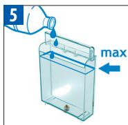
Spülen Sie den Wassertank aus bevor Sie ihn mit Trinkwasser bis zum maximalen Füllstand füllen.
