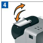
Tasse entnehmen. Hebel öffnen und schließen um die Kapsel in den Kapselbehälter auszuwerfen.
