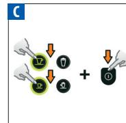
Lungo und Espresso Tasten drücken und gedrückt halten. Maschine einschalten.
