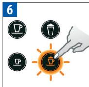
Cappuccino Taste drücken. Die Entkalkerflüssigkeit läuft abwechselnd durch den Kaffeeauslauf und die Entkalkungsdüse in die Abtropfschale. Cappuccino und Latte Macchiato Tasten blinken abwechselnd. Premere il pulsante Cappuccino. La soluzione decalcificante passa alternativamente attraverso l'erogatore di caffè, il tubo di decalcificazione e il vassoio raccogligocce. I pulsanti Cappuccino e Latte Macchiato lampeggiano alternativamente.
