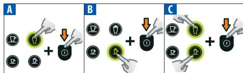
Die entsprechenden Tasten drücken und gedrückt halten. Maschine einschalten. Tenere premuti i pulsanti indicati e accendere la macchina.
