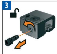
Rapid Cappuccino System Verbindung entfernen, indem Sie sie gemäß der Abbildung (🔒) drehen und abnehmen.
