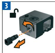
Verwijder de aansluiting voor het Rapid Cappuccino Systeem door het van stand (🔒) in de stand (🔓) te draaien en vervolgens los te trekken.
