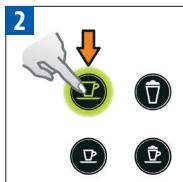
Houd de Espresso- of de Lungo-toets ingedrukt. De koffie wordt nu bereid. Functietoets knippert snel: programmeren waterhoeveelheid.
