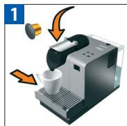
Wassertank füllen, Maschine einschalten und Kapsel einlegen. Hebel schließen und Tasse unter Kaffeeauslauf platzieren.
