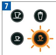
Zodra de ontkalkingsprocedure voltooid is (het waterreservoir raakt leeg), gaat de Cappuccino-toets knipperen. Όταν ο κύκλος καθαρισμού καθαλατώσεων έχει ολοκληρωθεί (το δοχείο νερού είναι άδειο), το κουμπί Cappuccino αναβοσβήνει.
