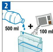
Abtropfschale und Kapselbehälter entleeren. Wassertank mit 100 ml Nespresso Entkalkermittel und 500 ml Wasser füllen.
