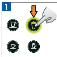
Cappuccino oder Latte Macchiato Taste drücken und gedrückt halten. Die Milchschaumbereitung startet. Taste blinkt schnell: Programmiermodus. Premere e tenere premuto il pulsante Cappuccino o Latte Macchiato. La preparazione della schiuma di latte inizia. Il pulsante lampeggia velocemente: modalità di preparazione.
