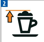
Puścić przycisk, gdy osiągnięty zostanie porządkany poziom piany. Podświetlenie przycisku mruga szybko: tryb programowania. Отпустите кнопку, когда желаемый объем молочной пены получен. Кнопки мигают быстро: режим программирования.
