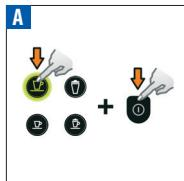
Przytrzymać i przytrzymać przycisk Lungo i włączyć urządzenie.
