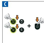
Przytrzymać i przytrzymać jednocześnie przyciski Lungo i Espresso i włączyć urządzenie.
