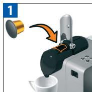
Zvedněte úplně páku a vložte kapsli. Zavřete páku a postavte šálek pod kávovou výpust.
