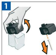
Retire la tapa del recipiente para leche y desconecte el tubo de aspiración de leche. Remova a tampa do recipiente de leite e desconecte o tubo de aspiração de leite
