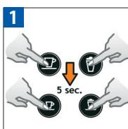
Wcisnąć wszystkie 4 przyciski na 5 sekund (gdy urządzenie jest włączone). Podświetlenia wszystkich przycisków mrużą 3 razy: wszystkie objętości są przywrócone do wartości początkowych.
