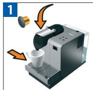
Napełnić zbiornik na wodę, włączyć urządzenie i włożyć kapsulkę. Zamknąć dźwignię i umieścić filiżankę pod wyłotem kawy.
