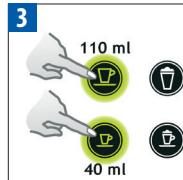
Pulse el botón Espresso (40 ml) o el botón Lungo (110 ml). La preparación terminará automáticamente. Para interrumpir el flujo de café o llenar al máximo su café, vuelva a pulsar el botón. Pressione o botão Espresso (40 ml) ou Lungo (110 ml). A extração terminará automaticamente. Para parar ou encher mais, prima novamente.
