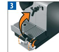
Otworzyć klapkę schowka na rurkę do odkamieniania. Podłączyć rurkę do odkamieniania do konекторa pary w urządzeniu. Otwórz klapkę schowka na rurkę do odkamieniania. Podłączyć rurkę do odkamieniania do konекторa pary w urządzeniu. Otwórz klapkę schowka na rurkę do odkamieniania. Podłączyć rurkę do odkamieniania do konекторa pary w urządzeniu.
