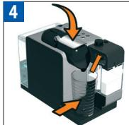
Cierre la palanca, coloque una taza de Cappuccino o un vaso para Latte Macchiato bajo la salida de café y ajuste la posición del surtidor de leche.
