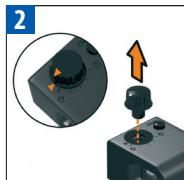
Extraiga la rueda reguladora de espuma haciéndola girar hasta (►) y tirando de ella hacia arriba. Retire o regulador de espuma de leite virando-o até (►) e puxe-o.
