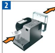
Vyjměte nádobu na vodu. Zavřete páku (bez vložení kapsle). Umístěte šálek pod výpust kávy. Vegye ki a víztartályt. Zárya le az emelőkart (a készülékben ne legyen kapszula). Helyezzen egy edényt a kávéműködő alá.
