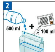
Vacie la bandeja antigoteo y el recipiente de cápsulas usadas. Llene el depósito de agua con 100 ml de agente descalcificador Nespresso y 500 ml de agua.
