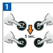
Stiskněte všechna 4 tlačítka a podržte po dobu 5 vteřin (při zapnutém přístroji). Všechna tlačítka 3 krát blikají: všechna množství jsou znova nastavena na původní hodnotu.
