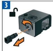
Odstraňte připojku systému Rapid Cappuccino System jejím odemčením od (🔒) do (🔓) a vytáhněte ji.
