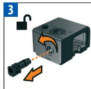
Extraiga el conector del Rapid Cappuccino System haciéndolo girar de (🔒) a (🔓) para desbloquearlo y tirando de él. Remova a ligação do Sistema Rapid Cappuccino desbloqueando-o de (🔒) até (🔓) e puxe-o.
