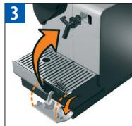
Otevřete dvírka prostoru pro uložení odvápnovační trysky. Nasadte odvápnovační trysku do připojky na páru.
