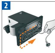
Vyměňte nádobu na vodu, odkapávací misku a kontejner na kapsle. Upravte délku kabelu tak, že ho vložíte do prostoru na kabel umístěný dole pod přístrojem.
