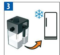
Odpojte systém pro přípravu mléčných nápojů R.C.S. od přístroje a umístěte ho do lednice. Uzávřete dvířka k připojce na páru na přístroji.
