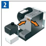
Zavřete nádobu na mléko. Otevřete dvířka k přípojce na páru jejich posunutím doprava. Připojte systém Rapid Cappuccino System k přístroji. Tlačítka Cappuccino a Latte Macchiato blikají: Rapid Cappuccino System se nahřívá. Svití: systém je připraven.
