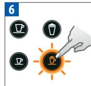
Pulse el botón Cappuccino. El descalcificador fluye alternativamente a través de la salida de café, el tubo de descalcificación y la bandeja antigoteo. Los botones Cappuccino y Macchiato parpadean alternativamente.
