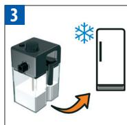
Desconecte el R.C.S. de la máquina y guárdelo en la nevera. Cierre la compuerta del conector de vapor.
