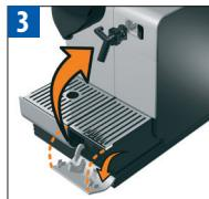
Abra la compuerta de almacenamiento del tubo de descalcificación. Conecte el tubo de descalcificación al conector de vapor de la máquina.
