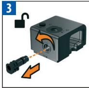
Usunąć konektor systemu Rapid Cappuccino przez przekręcenie go na (🔒) do (🔓) i pociągnięcie w bok. Отсоедините коннектор Системы приготовления молока, повернув в нужном направлении (🔒/🔓) и потянув.
