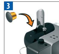
Unieść dźwignię i włożyć kapsułkę. Полностью поднимите рычаг капсулодержателя и вставьте капсулу.
