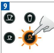
Pulse nuevamente el botón Cappuccino. El ciclo de enjuagado continúa a través de la salida de café, el tubo de descalcificación y la bandeja antigoteo hasta que el depósito de agua se vacía. Los botones Cappuccino y Macchiato parpadean alternativamente. Pressione novamente o botão Cappuccino. O ciclo de enxaguamento continua pela saída de café, tubagem de descalcificação e tabuleiro de gotejamento até que o reservatório de água fique vazio. Os botões Cappuccino e Macchiato piscam alternadamente.
