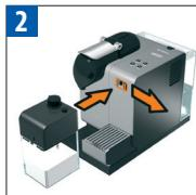
Zamknąć pojemnik na mleko. Otworzyć osłonkę konektora pary przesuwając go w prawo. Podłączyć System Rapid Cappuccino do urządzenia. Przyciski Cappuccino i Latte Macchiato migają: nagrzewanie. Światło stałe: gotowe.
