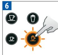
Stiskněte tlačítka Cappuccino. Odvápnovační roztok protéká střídavě výpustí na kávu, odvápnovační tryskou, a odkapávací miskou. Tlačítka Cappuccino a Macchiato střídavě blikají.
