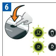
Włączyć urządzenie. Miganie przycisków: nagrzewanie przez około 40 sekund. Światło stałe: gotowe.
