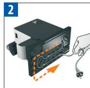
Wymień zbiornik na wodę, taczkę oczekową i pojemnik na kapsułki. Dostosować długość przewodu, a jego nadmiar umieścić w przeznaczonym do tego w głębiu pod urządzeniem.
