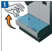
Retire la película de plástico de las rejillas izquierda y derecha y de los paneles de la máquina.
