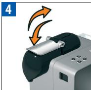
Usuń filiżankę. Podnieś i zamknij dźwignię w celu odrzucenia kapsułki. Уберите чашку. Поднимите и закройте рычаг, чтобы капсула упала в контейнер для сбора использованных капсул.
