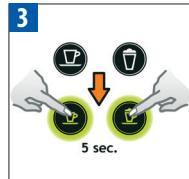
Pulse los botones Cappuccino y Espresso simultáneamente durante 5 segundos. Los botones de preparación parpadean alternativamente: modo de vaciado en curso.
