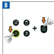
Przytrzymać i przytrzymać przycisk Espresso i włączyć urządzenie.
