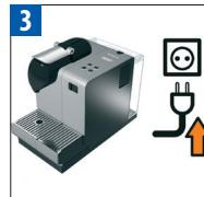
Postavte přístroj do vodorovné polohy. Zapojte přístroj do zásuvky.
