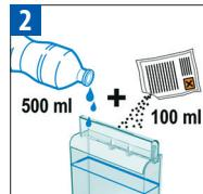
Vyprázdněte odkapávací misku a odpadní nádobu na kapsle. Napříte nádobu na vodu 100 ml odvápnovačního prostředku od Nespresso a doplňte 500 ml vody.
