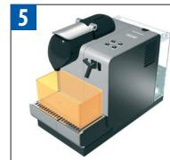
Umieścić pojemnik o objętości min. 1 litra pod otworem wylotu kawy i rurką do odkamieniania.
