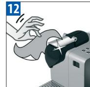
Vyčistěte kávovar s pomocí vlhkého hadíku. Nyní jste dokončili odvápnění přístroje. A gépet nedves ruhával tisztítsa le. Ezzel befejezte a gép vízkőmentesítését.
