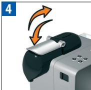
Extraiga la taza. Levante y cierre la palanca para expulsar la cápsula al recipiente de cápsulas usadas.
