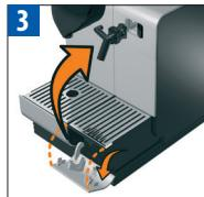
Otevřete dvírka prostoru pro uložení odvápnovačního hadičky. Zapojte odvápnovační hadičku do trysky na páru přístroje
