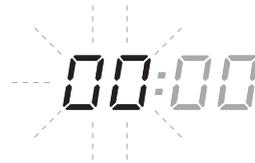
Die Stunden mit dem Drehknopf der Zeitschaltuhr (M) einstellen.
