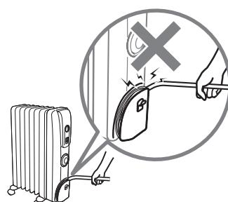
収納するときは、電源コードをコードホルダーに強く巻きつけないでください。電源コードを強く巻きつけると、コードの接続部が傷み、火災や感電の原因になります。
