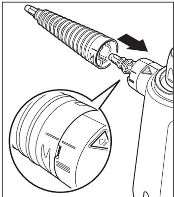
1. Stecken Sie die Strahldüse, die Mehrzweckdüse oder den Verlängerungsschlauch auf den Dampfaustritt. Die Markierung **I** auf der Düse bzw. dem Schlauch zeigt dabei auf die Markierung **I** am Gerät.
