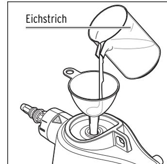
3. Füllen Sie den Messbecher maximal bis zum Eichstrich mit Leitungswasser oder destilliertem Wasser.
