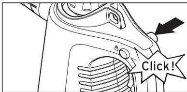
3. Drücken Sie die Verriegelungstaste wie abgebildet nach links, um die Dampftaste zu entriegeln.
