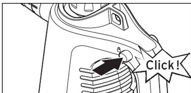
6. Drücken Sie die Verriegelungstaste wie abgebildet nach rechts, um die Dampftaste zu verriegeln
