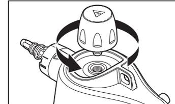
1. Schrauben Sie den Sicherheitsverschluss ab.
