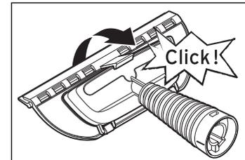
3. Drücken Sie die Mehrzweckdüse in Pfeilrichtung nach vorn, bis der Verschluss des Fensterwischers einrastet.
