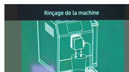
L'appareil commence la phase de rinçage des circuits internes et l'eau usée est évacuée par le bec verseur du café. L'écran de l'appareil affiche la page appropriée.
