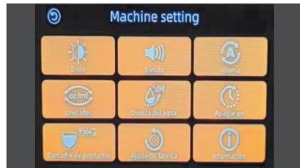
La primera vez que se utiliza el aparato, o después de restablecer los ajustes de fábrica, es necesario configurar el idioma del aparato, la unidad de medida y la dureza del agua.
