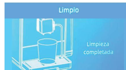
Repetir el programa de mantenimiento sin detergente para eliminar cualquier residuo del producto utilizado.
