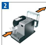
Wassertank entfernen. Hebel schließen (es darf keine Kapsel eingelegt sein). Behälter unter den Kaffeeauslauf stellen. Rimuovere il serbatoio dell'acqua. Abbassare la leva (senza capsula all'interno). Posizionare un contenitore sotto l'erogatore di caffè.
