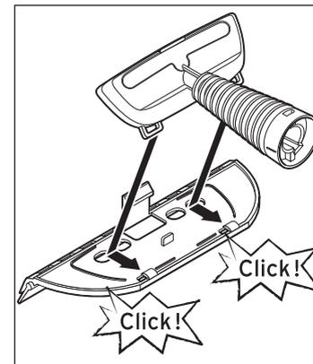
2. Setzen Sie die Mehrzweckdüse so schräg auf den Fensterwischer, dass die beiden hinteren Ösen in den Laschen einhaken.
