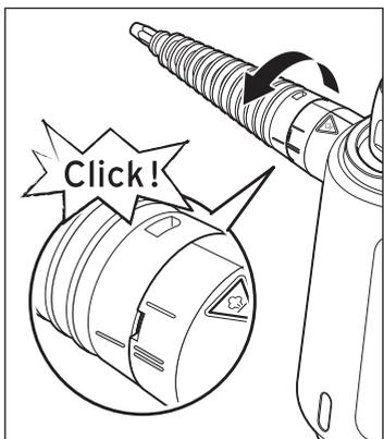
3. Drehen Sie die Düse bzw. den Schlauch in Pfeilrichtung. Die Markierung **I** auf der Düse bzw. dem Schlauch zeigt in der Endposition auf die Markierung **II** am Gerät.
