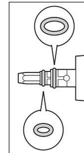
Je ein kleiner und ein großer Dichtring befinden sich am Dampfaustritt des Dampfreinigers selbst, an der Strahldüse und am Verlängerungsschlauch. Diese können bei Bedarf durch die im Lieferumfang enthaltenen Ersatz-Dichtringe ausgetauscht werden.
