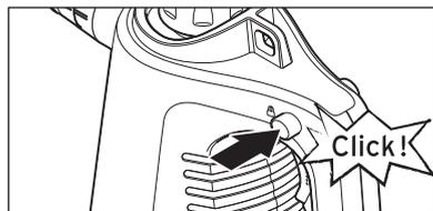
1. Drücken Sie die Verriegelungstaste wie abgebildet nach rechts, um die Dampftaste zu verriegeln.
