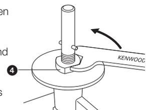
**Knethaken** – dieses Rührelement wird im Werk eingestellt und sollte keine Anpassung benötigen.
