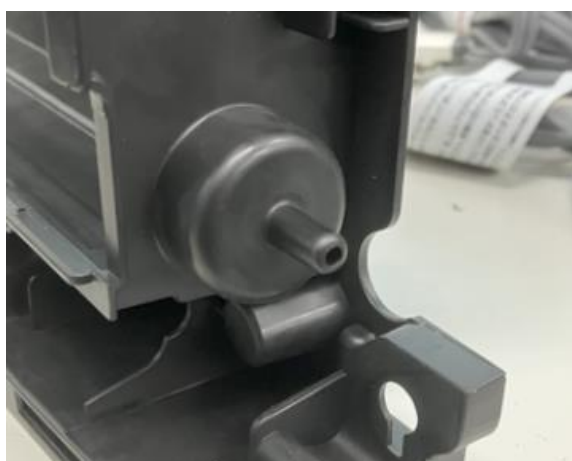
Telaio con tubo dell'acqua incorporato.
